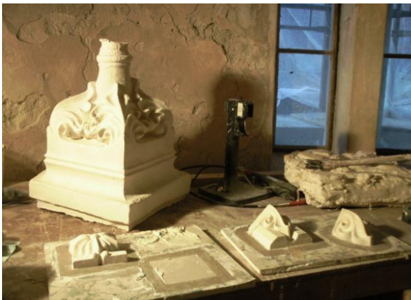
Det produseres gipskopier som danner grunnlaget for å lage støpeformene
